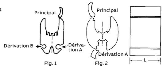
Ces connecteurs conviennent aux conducteurs standard de mêmes calibres à diamètre réduit de 3 % (comprimés).
