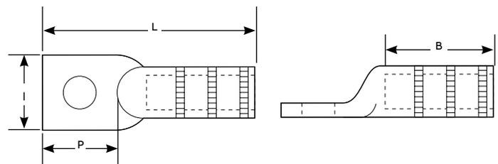
Pour l'étamage, ajoutez le suffixe « -TN » au numéro de catalogue. Toutes les cosses étamées sont répertoriées UL pour les applications d'un maximum de 1 000 kcmil. Pour des cosses droites à bouts coniques utilisées dans les applications haute tension, consultez votre représentant ABB.
