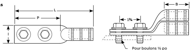
Pour l'étamage, ajoutez le suffixe « -TN » au numéro de catalogue. Toutes les cosses étamées sont répertoriées UL pour les applications d'un maximum de 2 000 kcmil. Pour des cosses droites à bouts coniques utilisées dans les applications haute tension, consultez votre représentant ABB. Taillées à un maximum de 1/4 po pour installer côte à côte sur des cosses à fourche NEMA.
