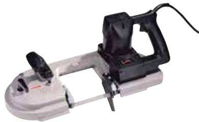
Une scie à ruban effectuera une découpe précise du revêtement de PVC, à la limite du conduit. Cependant, si le PVC est coupé à ras à l'extrémité du conduit, les dents de la matrice ne pourront pas mordre dans l'acier lors du processus de filetage.
