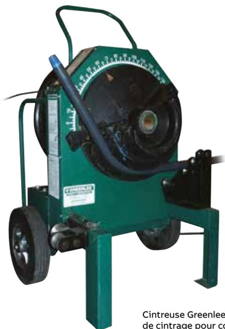
Cintreuse Greenlee modèle 555 et accessoires de cintrage pour conduits recouverts de PVC (ci-dessous)
