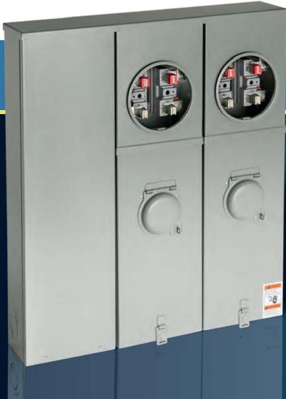
Combiné à positions multiples avec compartiment avec ou sans disjoncteur ; 200 A (bornes principales), 200 A par position, monophasé 120/240 V max.
