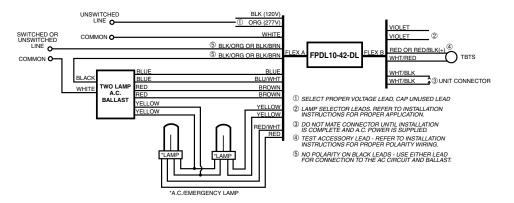
4. ALTERNATE TWO LAMP RAPID START BALLAST WITH ONE LAMP EMERGENCY OPERATION
